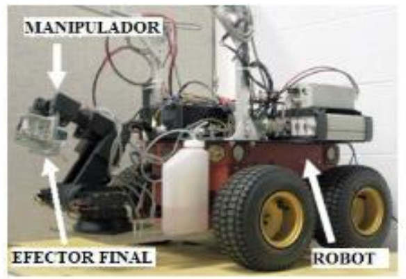
Figura 3. Robot de campo equipado con manipulador de 5 grados de libertad y efector micro-dosificación de aplicación directa. (Sogamoso, Aponte, & Solaque, 2015)
