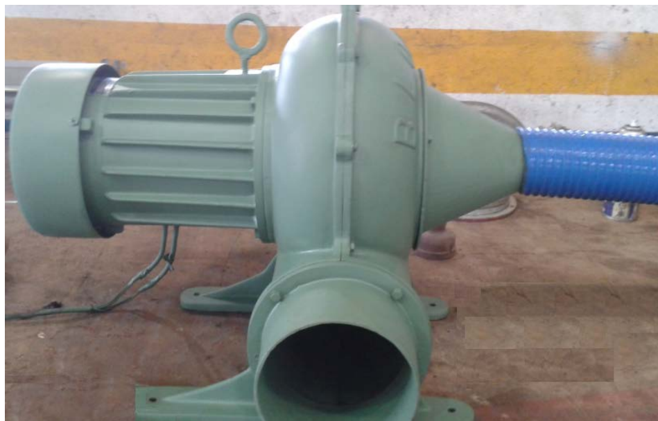
Figura 17: Ventilador centrífugo de 6 pulgadas habilitado para succión
