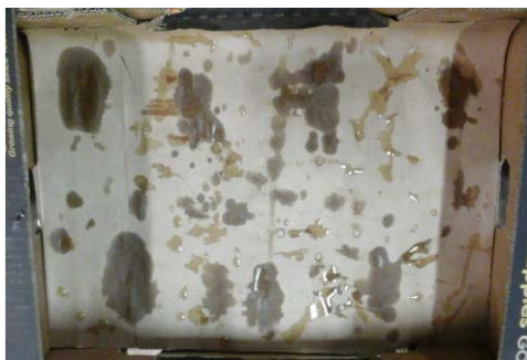
Figura 16: Distribución de las piñas en la caja y representación de los diferentes tamaños de las huellas de humedad para tres casos de estudio.
