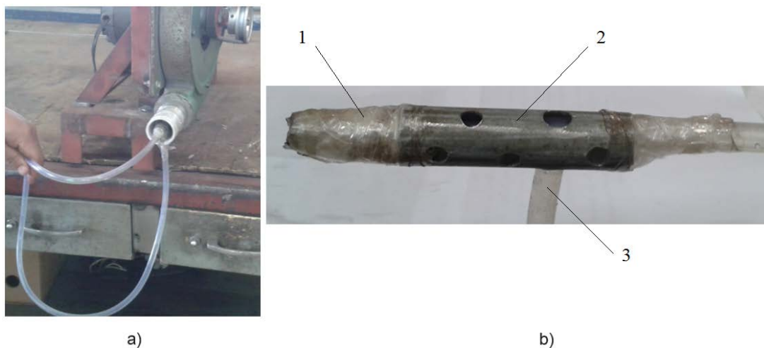
Figura 20: Tubo de Pitot utilizado para medir la velocidad a la salida del ventilador
