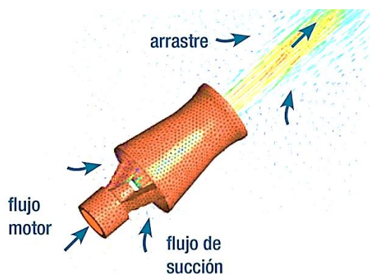
Figura 18. Funcionamiento del eductor (Körting, 2013)
