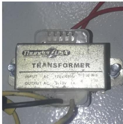
**Figura 1.** Transformador 127/12 VAC.
