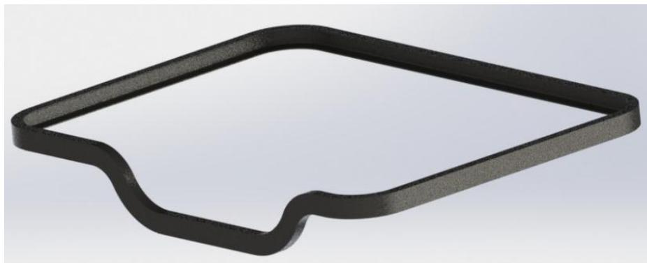
**Figura 17.** Riel de la cinta transportadora modelado en 3D.
