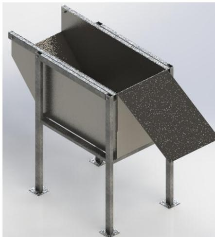
**Figura 29.** Modelado 3D de la batea de aturdimiento.
