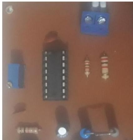
**Figura 9.** Tarjeta real de control de porcentaje de trabajo.
