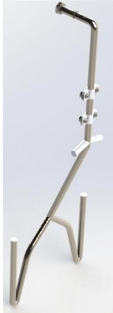
Figura 19. Modelado en 3D de gancho de carga.
