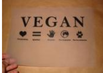
Figura 2. Imagen insolada impresa en acetato.
