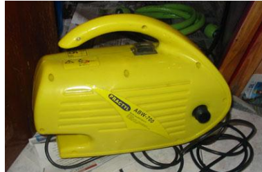
Figura 9. Hidrolavadora ayuda al lavado de la malla.
