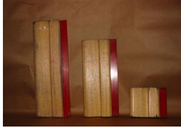
Figura 6. Racletas de toda medida sirven para el arrastre de tinta.
