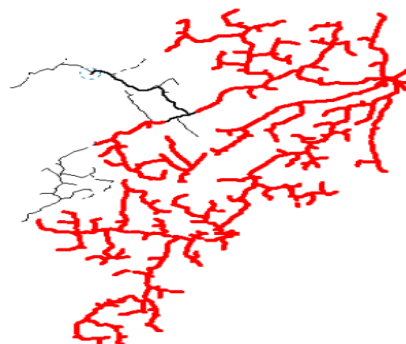
Figura 19. Condiciones anormales de tensión en situación actual Fuente: flujo de carga, CYMDIST
