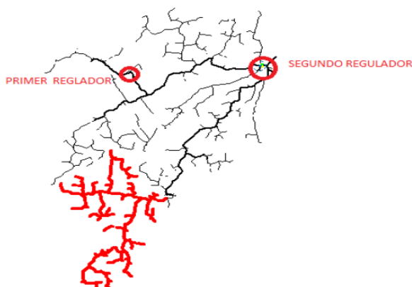
Figura 36. Ubicación de reguladores en el alimentador Rocío Puerto Limón
