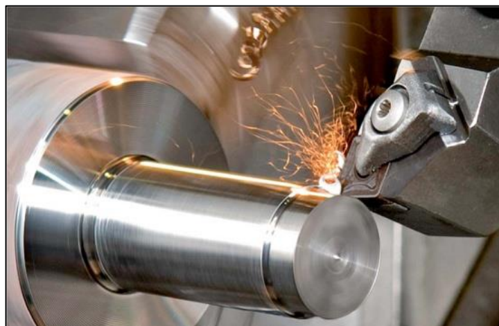
Figura 1. Mecanizado por arranque de viruta Fuente: Baker, Procesos básicos de manufactura, 2002
