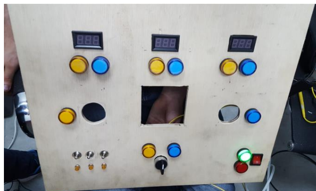
Figura 69. Perforaciones para controladores perillas etc.
