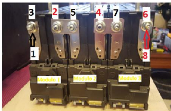
Figura 2. Disposición de conexión de bornera.
