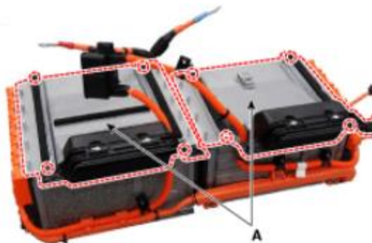
Figura 52. Desmontaje de cubierta de módulos de batería. (Hyundai Motor Co., 2017)
