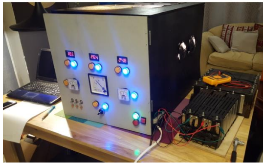
Figura 96. Banco de carga y descarga conectado.
