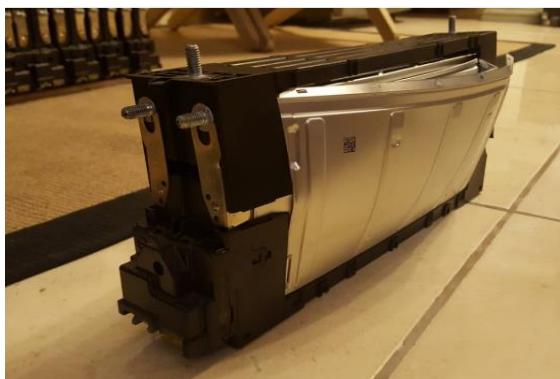
Figura 104. Daño en batería por bajo voltaje.
