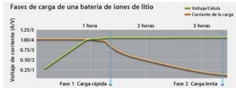
Figura 101. Ilustración de rango de trabajo de baterías tipo LiPo.
