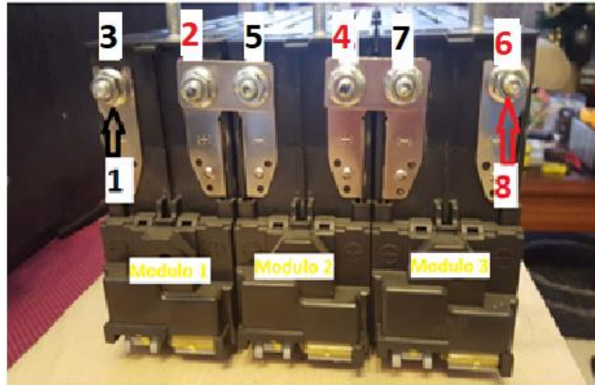
Figura 98. Disposición de conexión de bornera.
