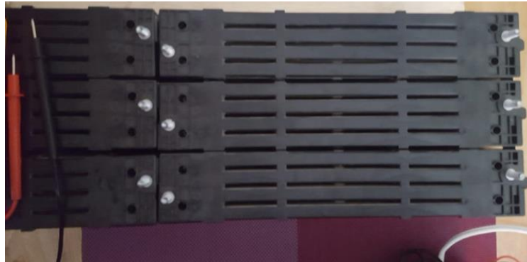
Figura 84. Secciones de ventilación a limpiar en módulos HEV
