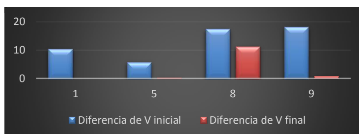
Figura 106. Resultado de diferencias de voltajes de módulos antes vs después del mantenimiento
