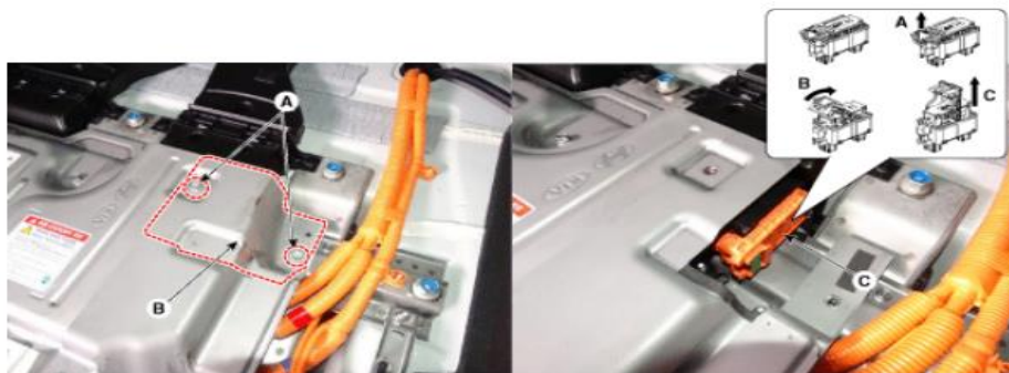
Figura 28. Procedimiento para desmontar el tapón de seguridad (Hyundai Motor Co., 2017)
