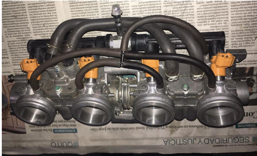
Figura 33. Montaje de ITBs.
