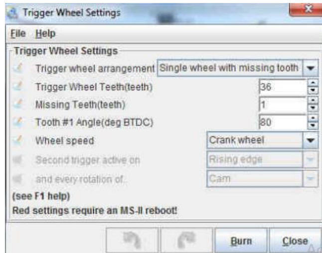
Figura 63. Configuración de rueda fonica. Fuente: (TunerStudio MS)
