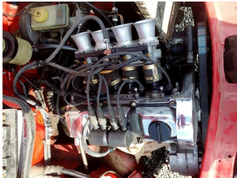
Figura 32. Montaje de múltiple de admisión diseñado con ITBs. Fuente: Autor.
