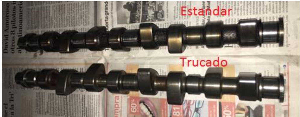
Figura 27. Comparación Árbol levas estándar, trucado Fuente: Autor
