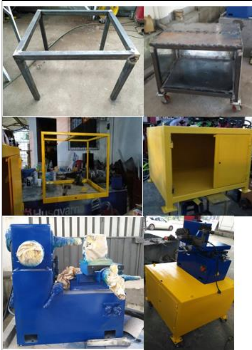
Construcción de la base y pintado de la rectificadora.
