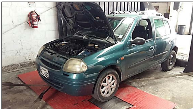
Figura 15. Prueba en dinamómetro – Renault Clio de serie Fuente: (Autor)
