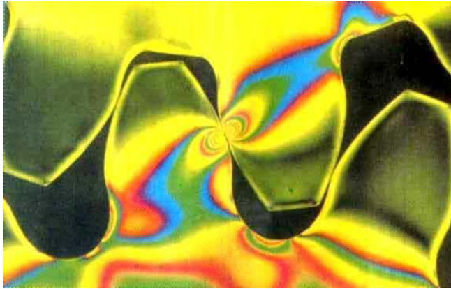
Fig. 48. Distribución de esfuerzos entre dos engranajes
