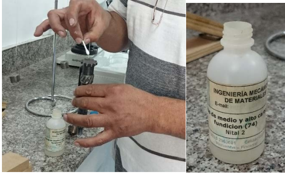
Fig. 44. Ataque químico con NITAL 2
