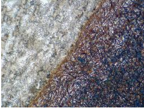
Fig. 46. Microestructura del acero a 50 micrómetros de profundidad de la superficie del diente. Atacado con Nital2, 400X.
