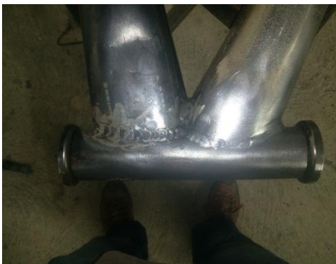
Figura 49. Rugosidad en las uniones de soldadura Fuente: Autor
