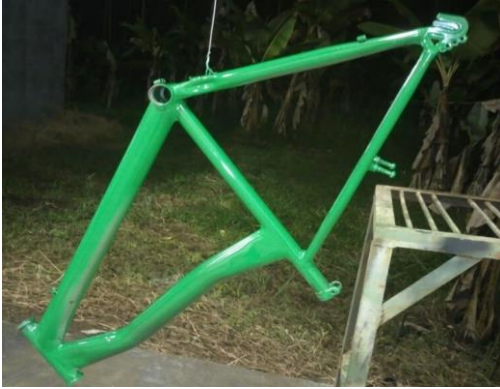
Figura 55. Finalización de la aplicación de la pintura base Fuente: Autor
