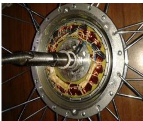
Figura 32. Bobinados internos del motor Fuente: Autor
