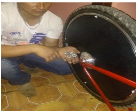
Figura 60. Colocación de tuercas y arandelas de presión al eje de la rueda Fuente: Autor
