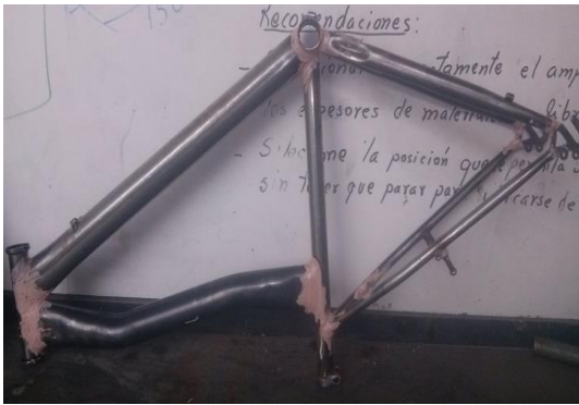
Figura 50. Aplicación de masilla en uniones Fuente: Autor
