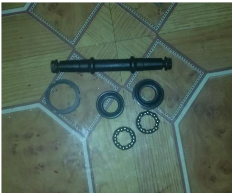
Figura 62. Eje, pistas y rodamientos de los de pedales Fuente: Autor
