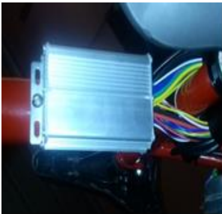
Figura 36. Ubicación del controlador Fuente: Autor
