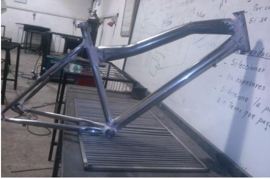
Figura 52. Estructura de la bicicleta terminada de lijar Fuente: Autor
