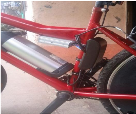
Figura 67. Colocación de la caja porta terminales Fuente: Autor
