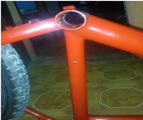
Figura 61. Orificio de alojamiento del eje de los pedales Fuente: Autor
