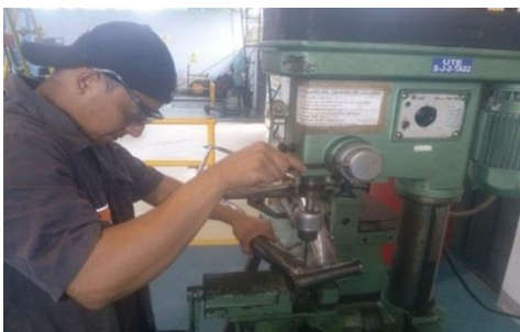
Figura 47. Orificio en el tubo superior del cuadrante Fuente: Autor
