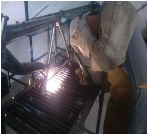
Figura 45 Soldadura del cuadrante posterior Fuente: Autor
