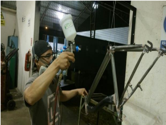
Figura 53. Aplicación de pintura base a la estructura Fuente: Autor
