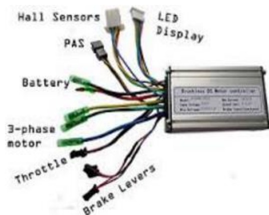
Figura 18. Controlador Fuente: (Kalkhoof, 2015)
