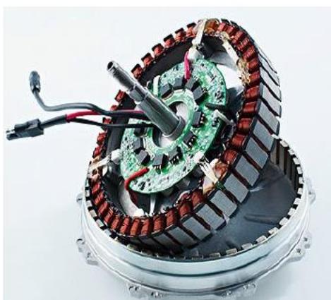
Figura 13. Motor DC sin escobillas Fuente: (Galindo, 2015)
