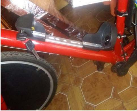
Figura 63. Base de la batería de litio-Ion Fuente: Autor
