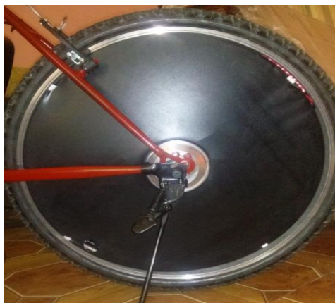
Figura 31. Parte externa del motor Brushless Fuente: Autor
