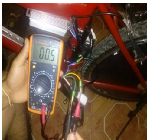
Figura 33. Medición de fases del motor Fuente: Autor
