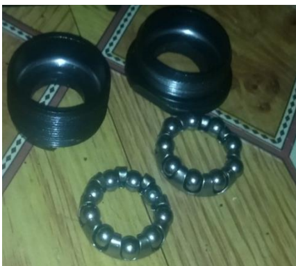
Figura 59. Rodamientos utilizados en el tubo de dirección Fuente: Autor
