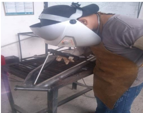
Figura 46. Soldadura del tubo superior del cuadrante Fuente: Autor
