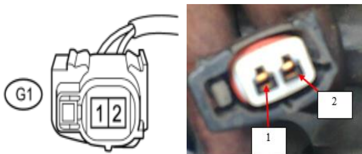
Figura 126. Inspección del sensor de golpeteo (1)
