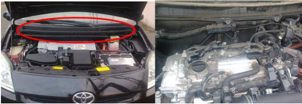
Figura 152. Cubierta de aluminio ubicada sobre las bobinas
