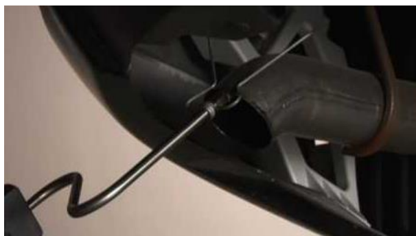
Figura 151. Conexión de la sonda del analizador de gases a la salida del tubo de escape
