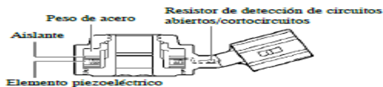
Figura 62. Estructura del sensor de detonación
