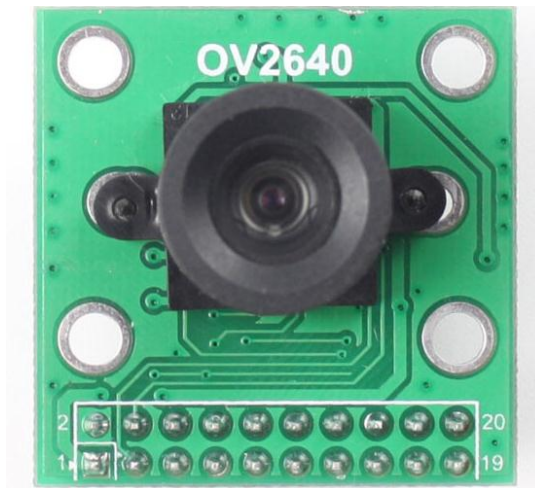
Figura 12. Cámara OV2640 (ArduCam,2015)
