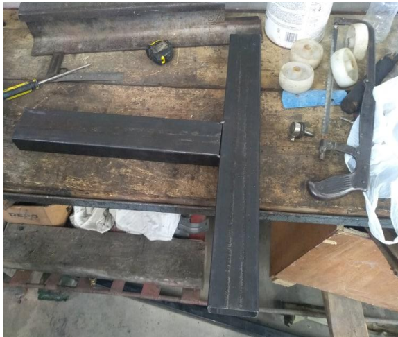
Figura 18 Construcción de la base del Luxómetro
