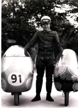
Figura 6 Carenado tipo dustbin de Guzzi y Tipo delfín de NSU 1954. (Mick Woollet 2016)
