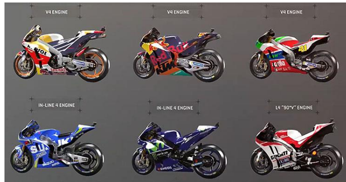
Figura 2. Tipos de motos según su posición de motor (motoGP 2017).
