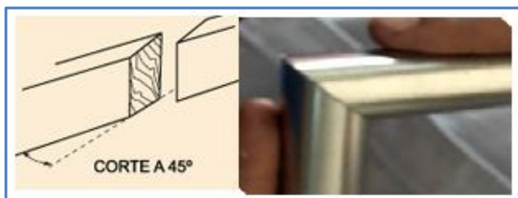
Figura 24. Corte y unión de bisel doble a 45^\circ
