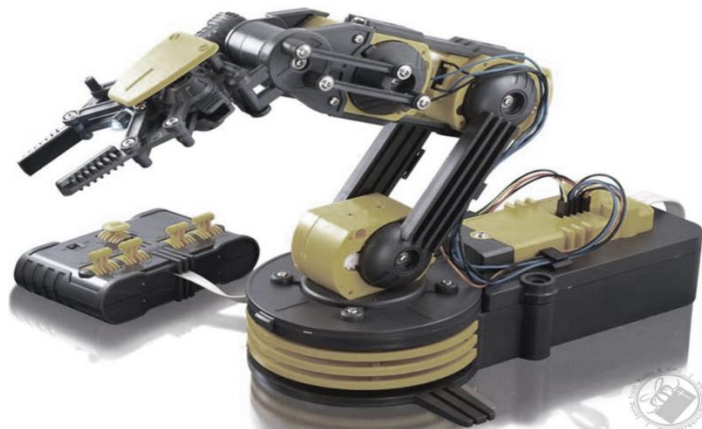
Fig. 5. Brazo Manipulador. Configuración Esférica - Polar Fuente: https://www.emaze.com/@ALWCLOIR/Presentation-Name
