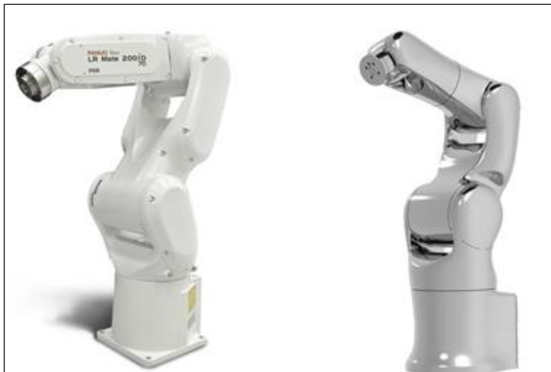
Fig. 10. Manipuladores utilizados en Salas blancas
