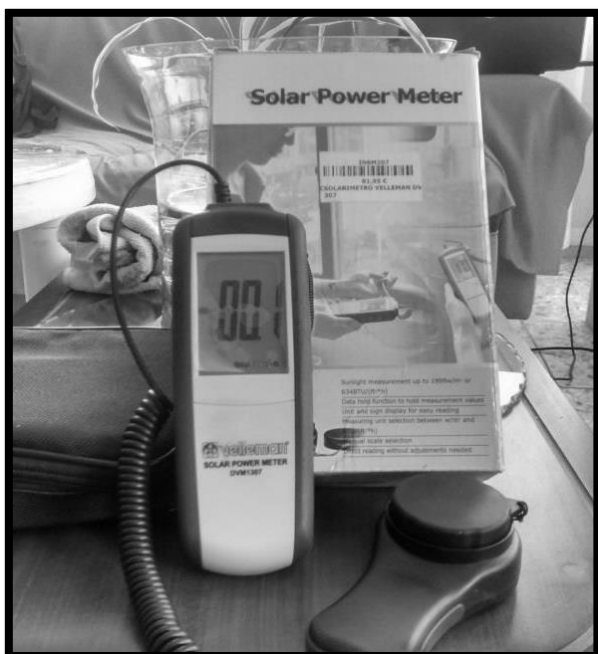
Figura 7: Piranómetro marca Velleman
