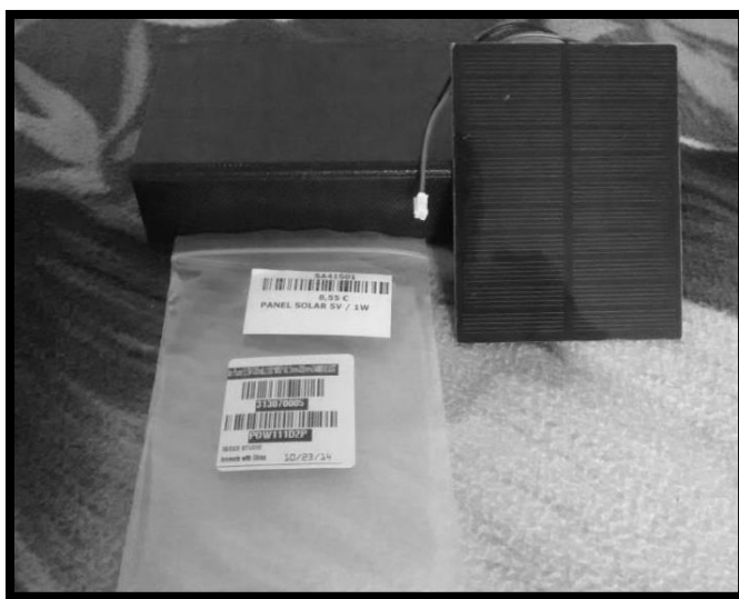
Figura 1: Célula fotovoltaica monocristalina adquirida
