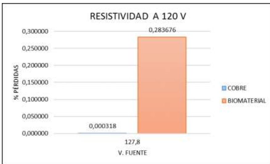
Figura 16. Caída de Tensión Cobre vs Biomaterial 120V
