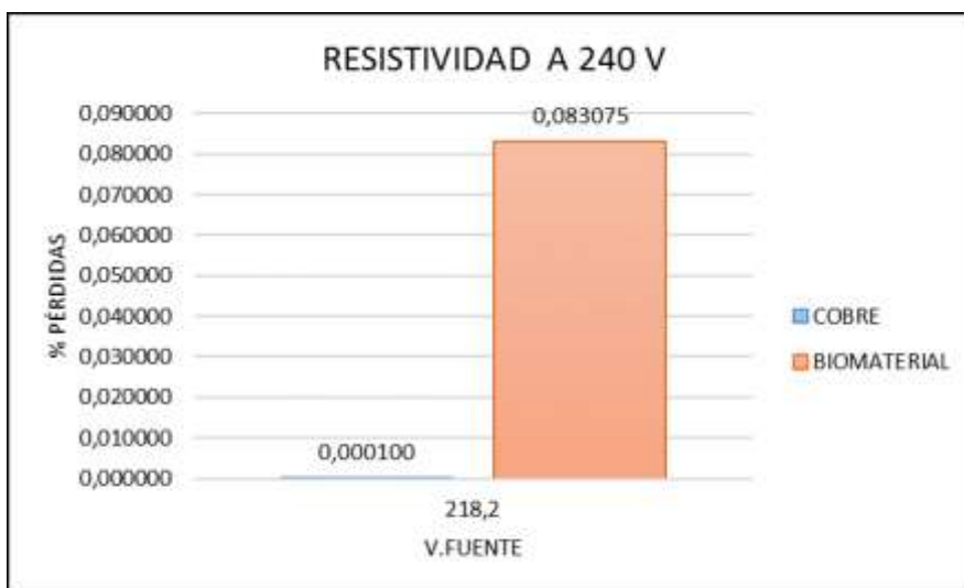
Figura 17. Caída de Tensión Cobre vs Biomaterial 240V
