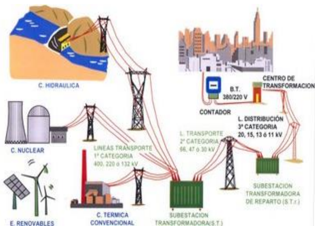
Figura 1: Distribución y Generación de energía eléctrica.
