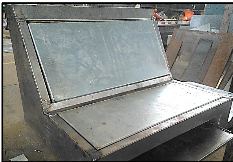
Gráfico N° 24: Estructura de compuertas del módulo.
