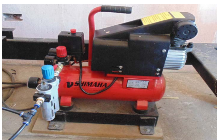
Figura N. 73 Compresor y unidad de mantenimiento Fuente: Investigación de campo Elaborado por: Jorge Boas
