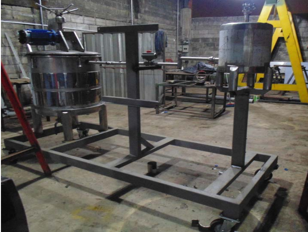
Figura N. 10 Biorreactor tipo batch entregado por la empresa promecind
