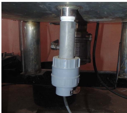
Figura N. 67 Sonda De PH con amplificador Fuente: Investigación de campo Elaborado por: Jorge Boas
