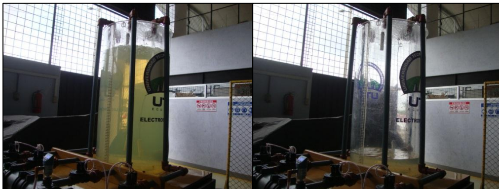
Gráfico N° 4.43 Proceso de vaciado del tanque reservorio
