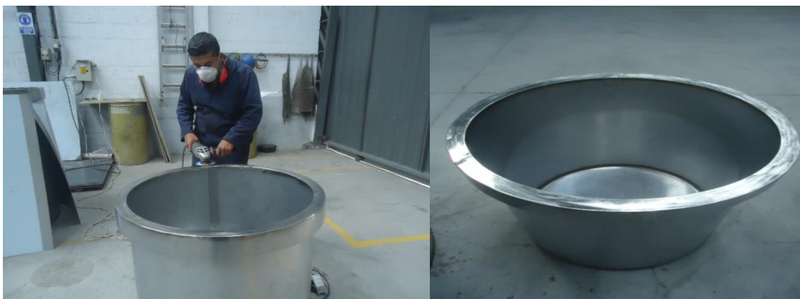
GRAFICO N° 4.6 Pulido de soldadura.
