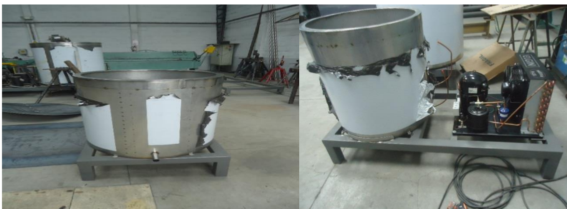
GRAFICO N° 4.15 Unidad condensadora y Tanque de refrigeración.
