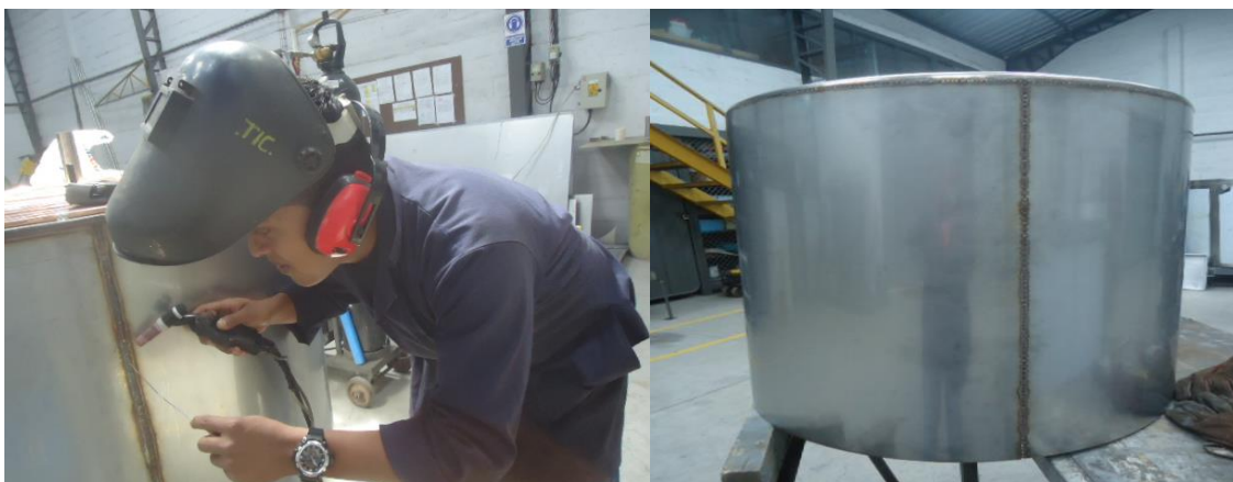
GRAFICO N° 4.1 Proceso de soldadura del tanque
