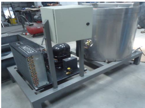
GRAFICO N° 4.25 Tanque de refrigeración
