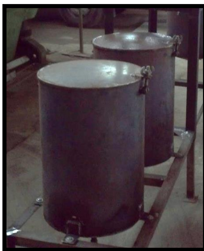
Gráfico N° 5.1 Tanque de aceite vegetal y metanol
