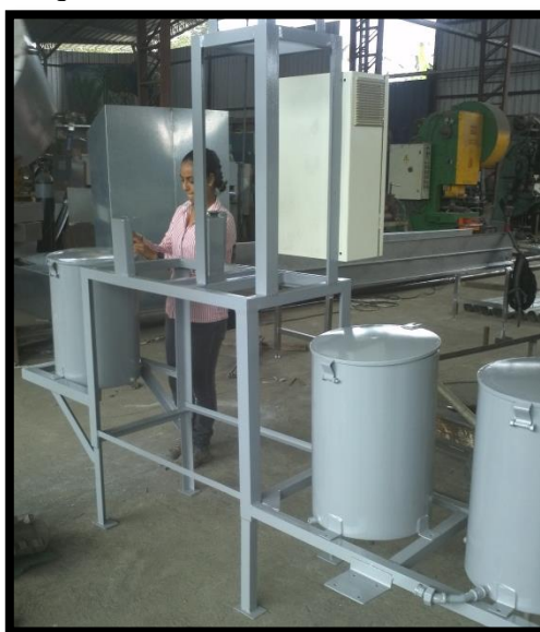
Gráfico N° 5.11 Ajuste de los tanques de metanol, aceite, almacenamiento y purgas
