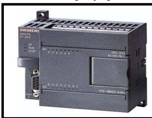
Gráfico N° 2.6 Controlador lógico programable
