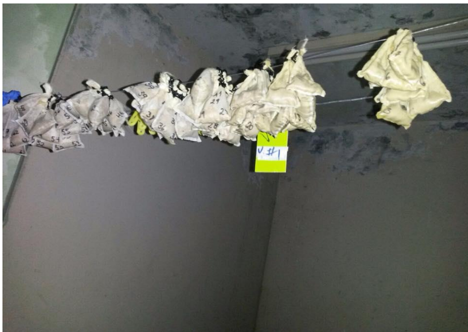
Figura 14. Secado previo al ambiente de las bolsitas con material pos incubado antes del ingreso a la estufa
