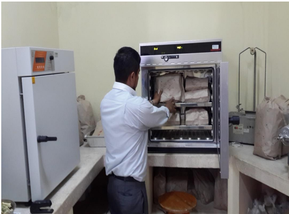
Figura 6. Análisis del material forrajero en el laboratorio para determinación de Materia Seca (MS)
