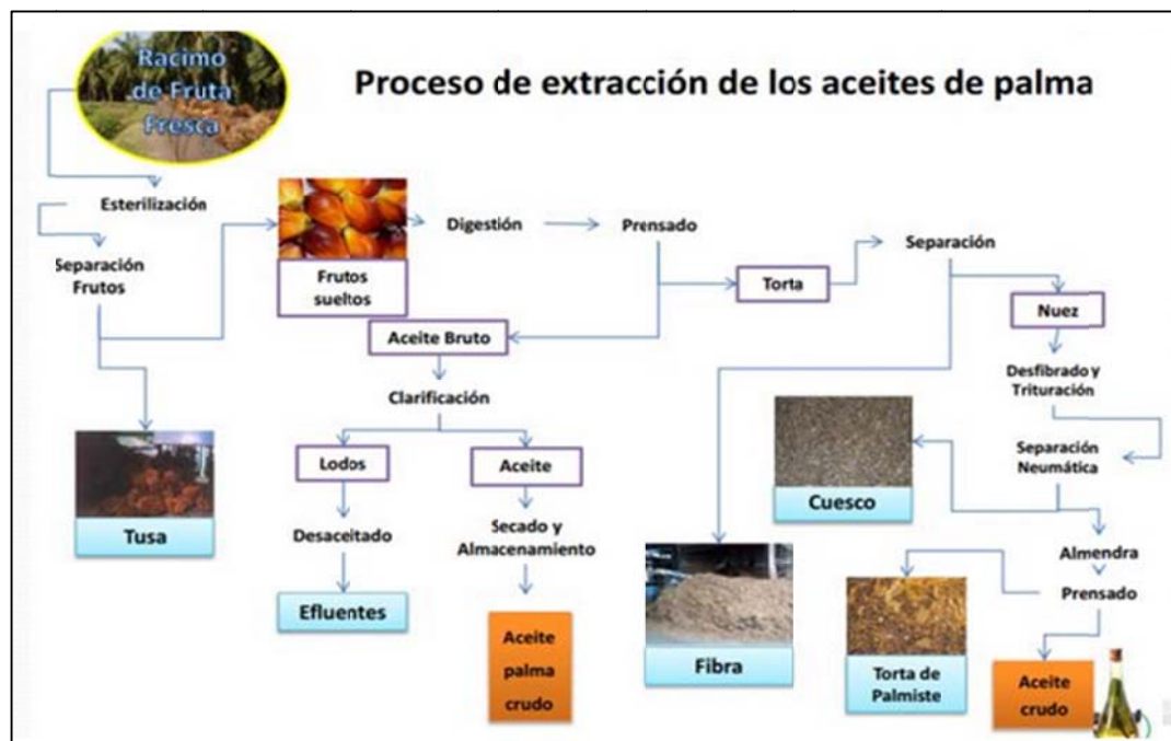
Figura 2.26. Esquema del proceso de extracción de aceite de palma (Foto: FEDEPALMA, 2015).
