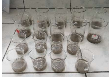
Figura 7. Mezcla de agua de formación con sólidos dispersos.
