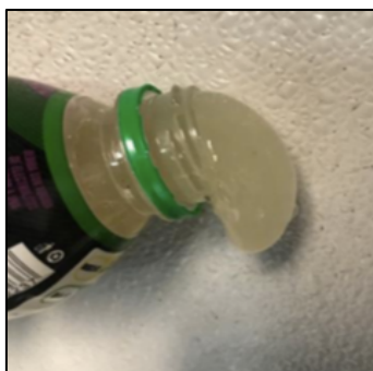
Figura 13. Imagen del fluido denominado 'pad' bombeado en el pozo EDYJ-081. Tomado de (Schlumberger, 2010).
