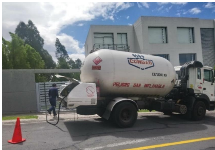
Figura 11.- Abastecimiento del Autotanque – Vehículo Granelero de GLP
