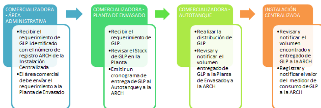
Figura 14.- Proceso de control del abastecimiento de GLP
