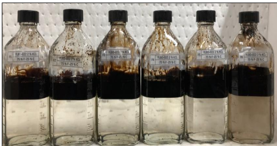
Figura 22. Compatibilidad 75% Fluido de control - 25% de crudo
