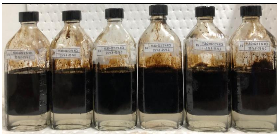
Figura 20. Compatibilidad 25% Fluido de control - 75% de crudo
