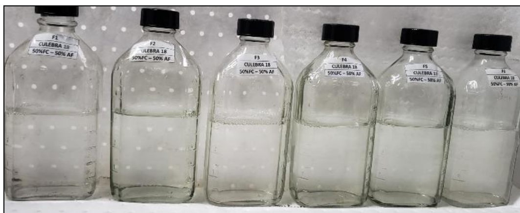
Figura 19. Compatibilidad 50% Fluido de control - 50% Agua de Formación
