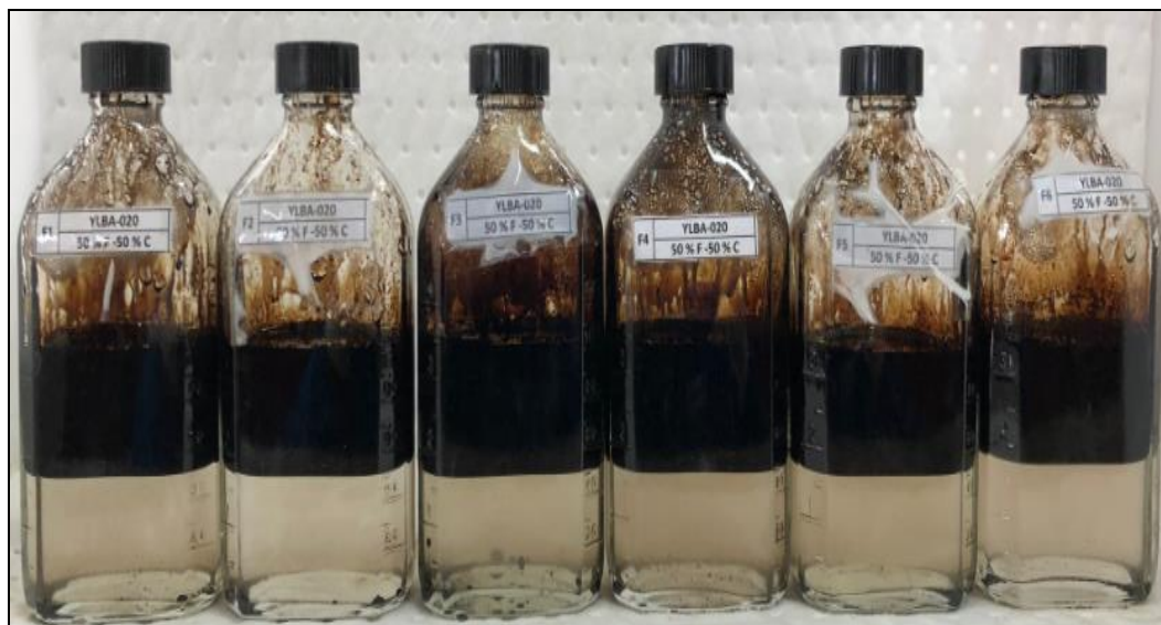
Figura 21. Compatibilidad 50% Fluido de control - 50% de crudo
