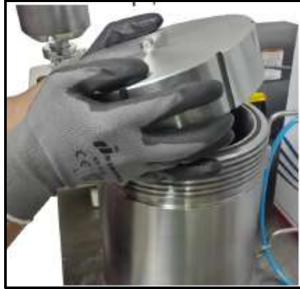
Figura 4. Cilindro saturador de tapones. C&CO Services S.A.S. 2015
