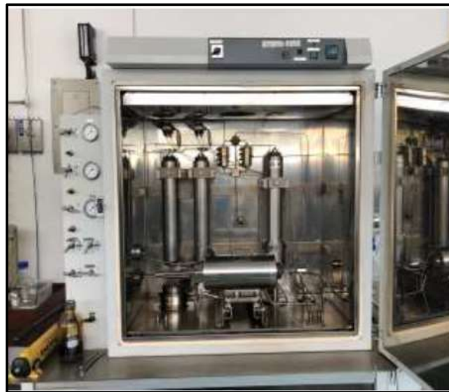
Figura 13. Equipo de Simulación de daños a la Formación (SDF). VINCI Technologies
