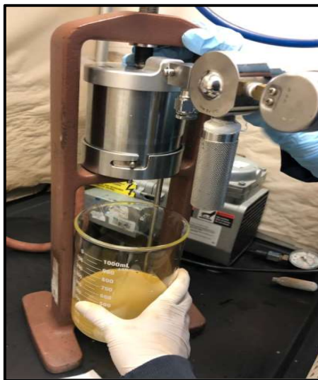
Figura 7. Filtración del fluido de control
