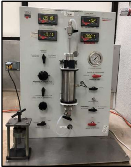
Figura 3. Porosímetro-permeámetro. VINCI Technologies. 2009
