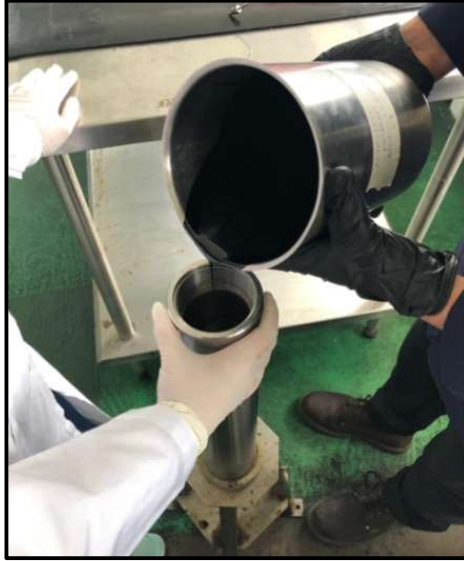
Figura 12. Carga de fluidos en acumuladores
