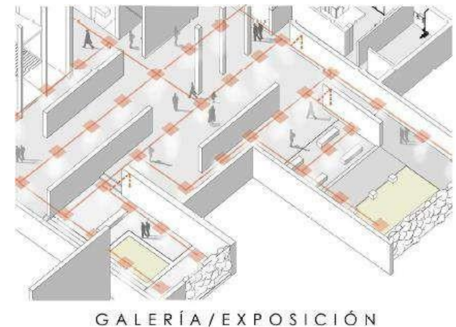
Figura 46: Esquema de distribución eléctrica - galería. Elaboración propia
