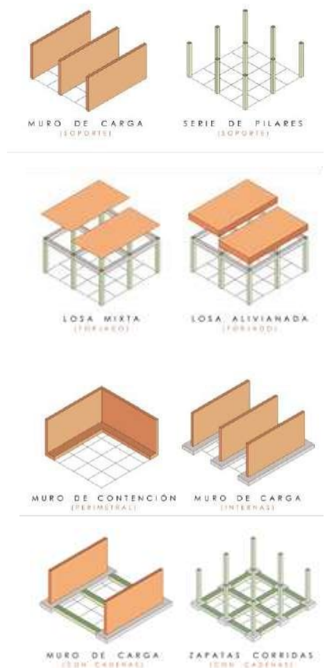
Figura 40: Esquemas criterio estructura y cimentación Elaboración propia.
