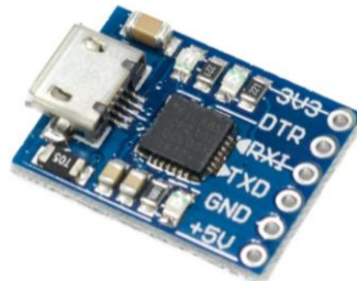
Figura 12. Diseño esquemático del Módulo CP2102 puente USB a UART. (LABS, 2018)
