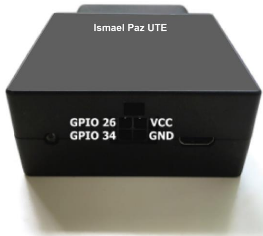
Figura 23. Dispositivo de puerta de enlace con los puertos externos para conectar la batería LiPo o algún sensor adicional para analizar una variable adicional que desee el cliente.
