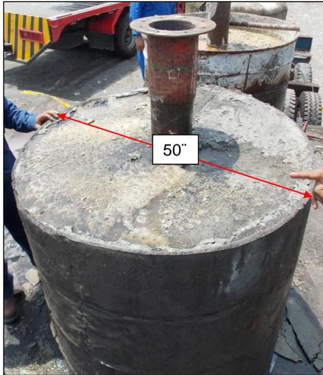
**Figura 17.** Anillo de cemento de 50 pulgadas y casing a punzonar
