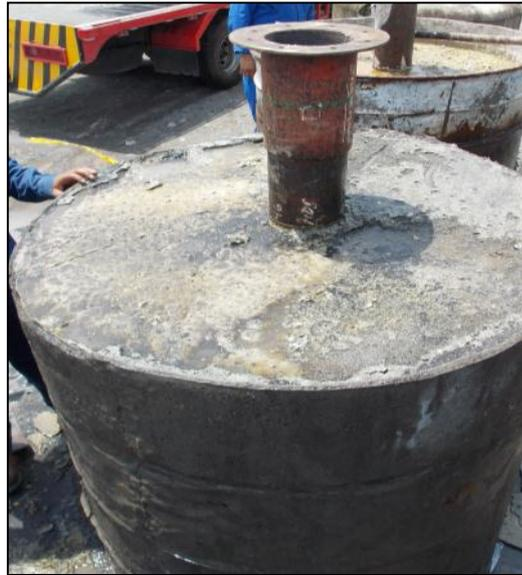
**Figura 14.** Anillo de cemento para prueba del ECP Technology.
