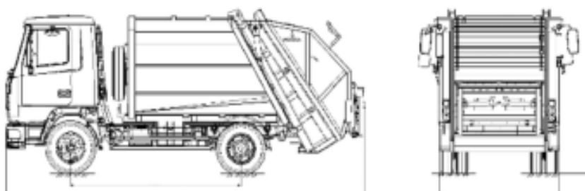
Camión de basura con carga trasera MAZ-5904B2-10 en el chasis MAZ-5340B2-425-013P1 (4 x 2)
