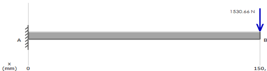
Figura 11. Diagrama de fuerzas del eje horizontal
