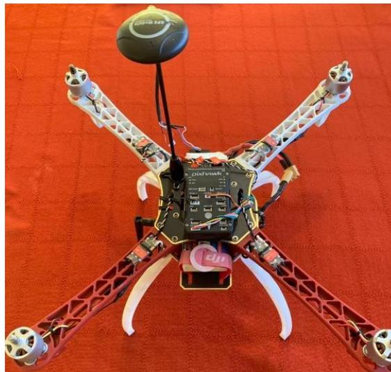
**Figura 16.** Fotografía del cuadricoptero seleccionado y armado
