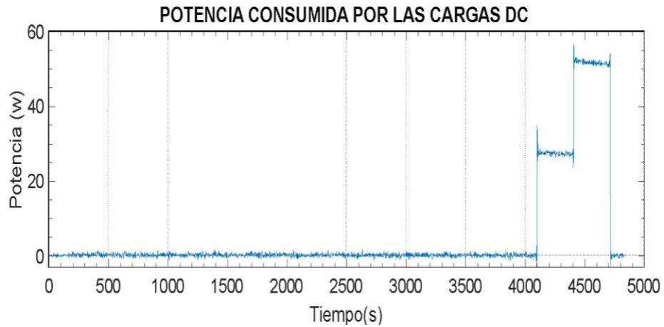
Figura 35. Potencia absorbida por las lámparas en DC
