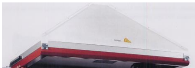
Figura 12. Lámpara reflectora de AC (simulador solar) (Lab-Volt, 2012)
