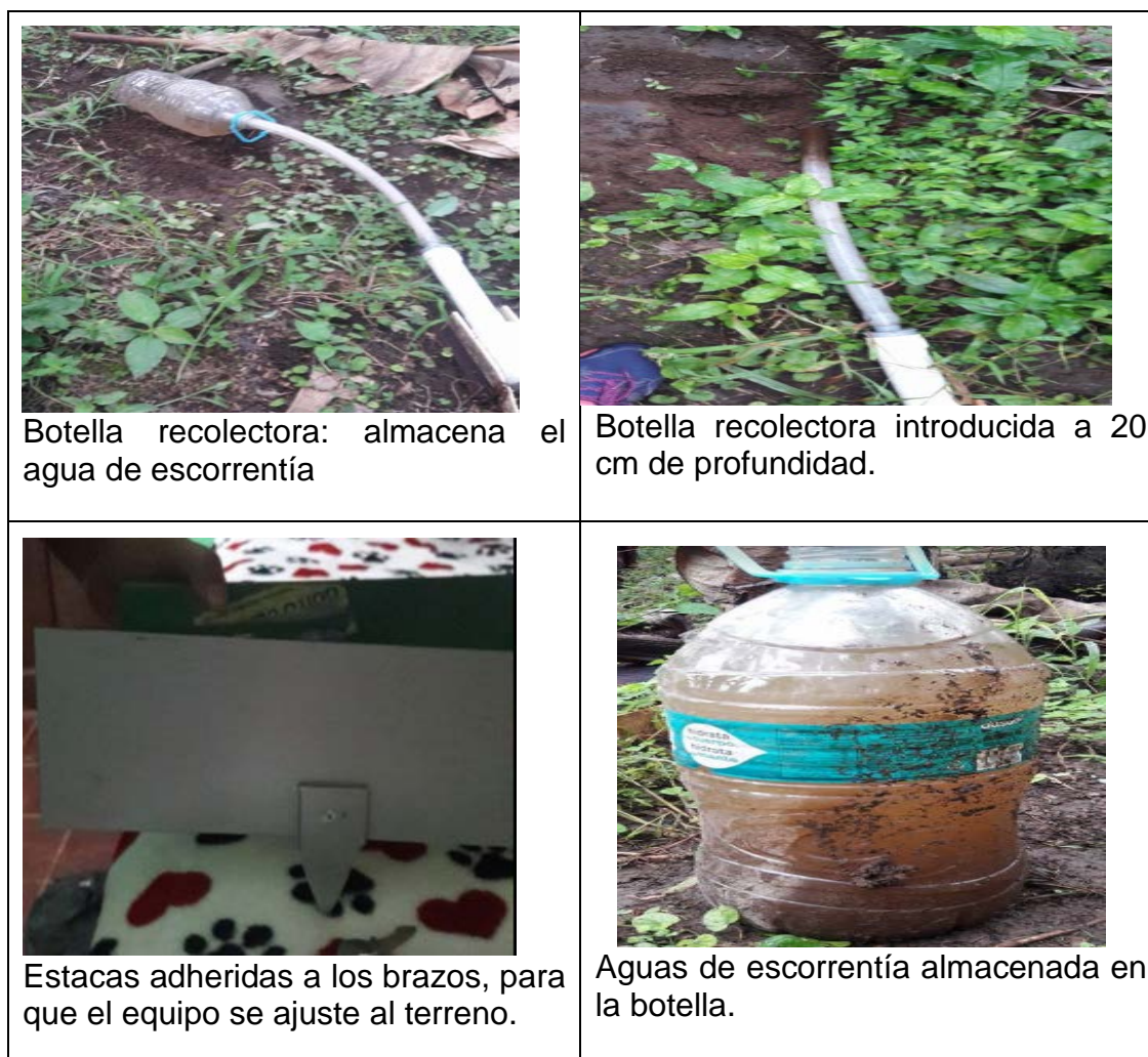
Fig. 4. Matriz de avance y construcción de los “Brazos recolectores de escorrentía”, Santo Domingo, Ecuador, 2018.
