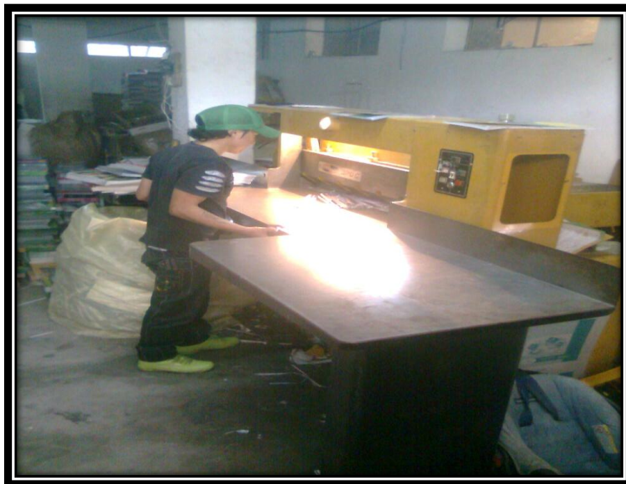
Foto N°5 Tema: Maquinaria Cortadora para terminados de libros
