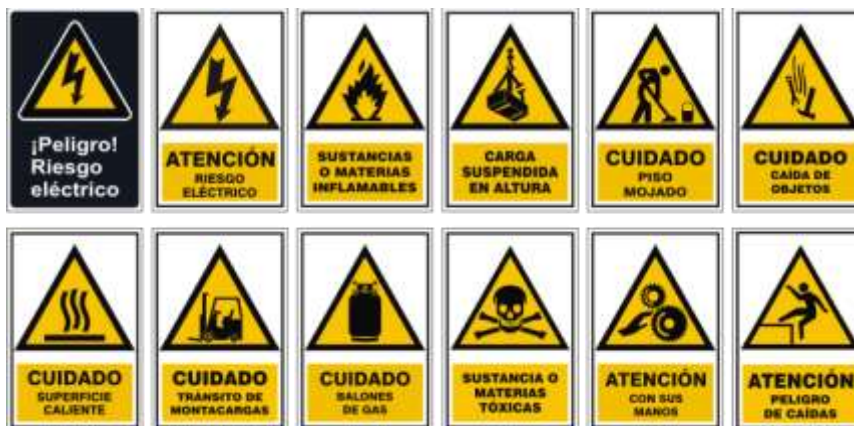
Figura 5.3 Señales de advertencia
