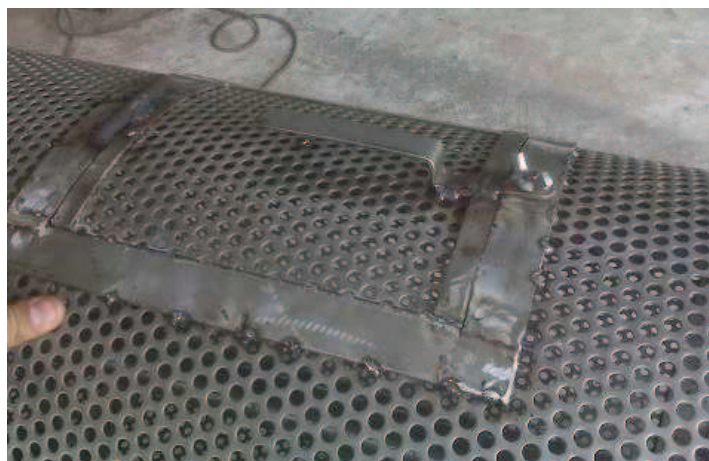
Figura: 6-4 Compuerta de carga
