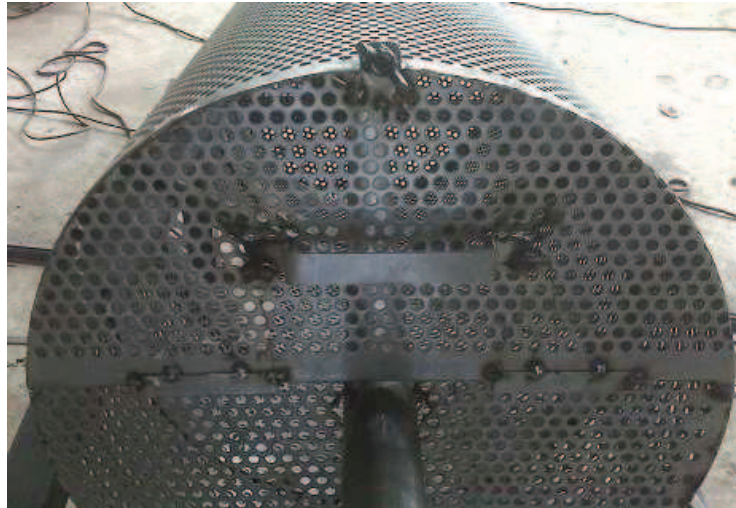
Figura: 6-5 Compuerta de descarga
