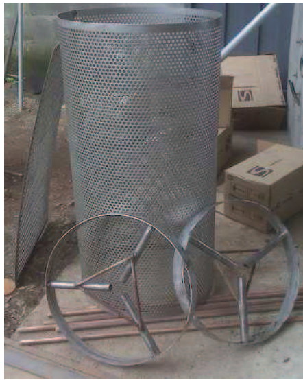
Figura: 6-3 Rolado lamina perforada de 2mm
