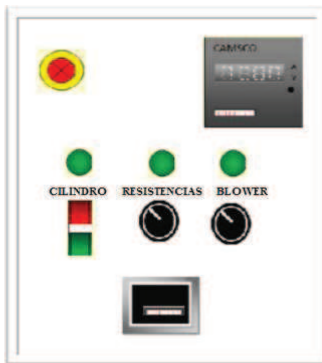
Figura: 6-11 Tablero de control eléctrico
