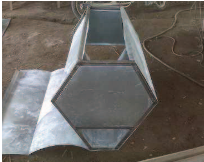
Figura: 6-9 Construcción del aislamiento térmico
