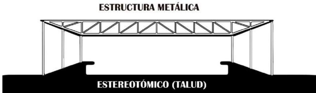
Imagen 9. Estructura Centro recreacional, deportivo y cultural
