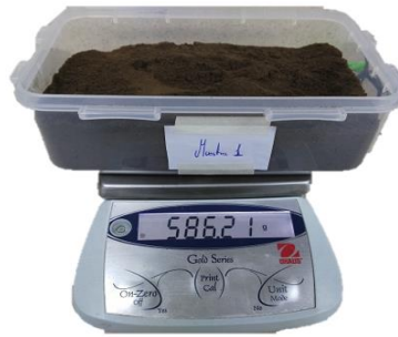
Figura 35. Muestra con 0 ml de líquido
