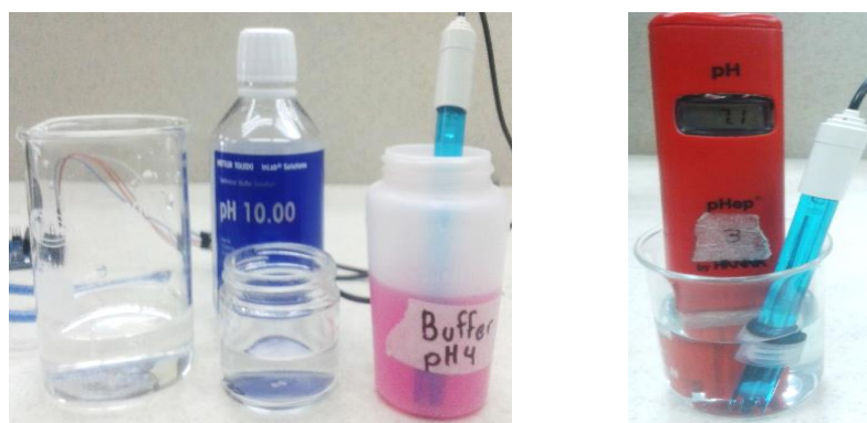
Figura 29. Calibración del sensor de pH SEN0161
