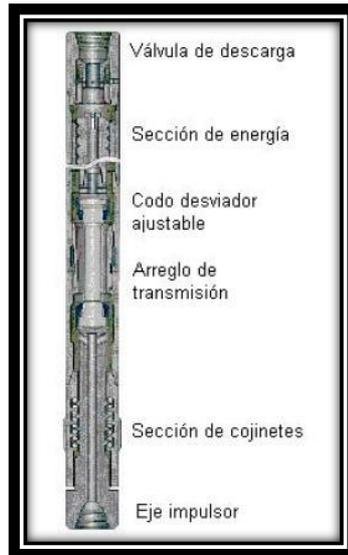
**Figura 21.** Sección transversal de un motor de fondo
