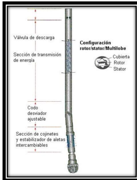
**Figura 20.** Arreglo de un motor dirigido
