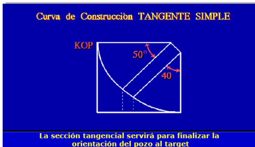
Figura 36. Pozo horizontal curva de construcción tangente sencilla
