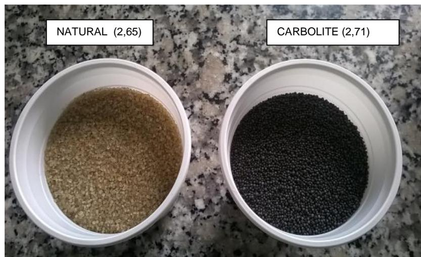
**Figura 18.** Tipos de arena y gravedad específica para lograr la abrasión.
