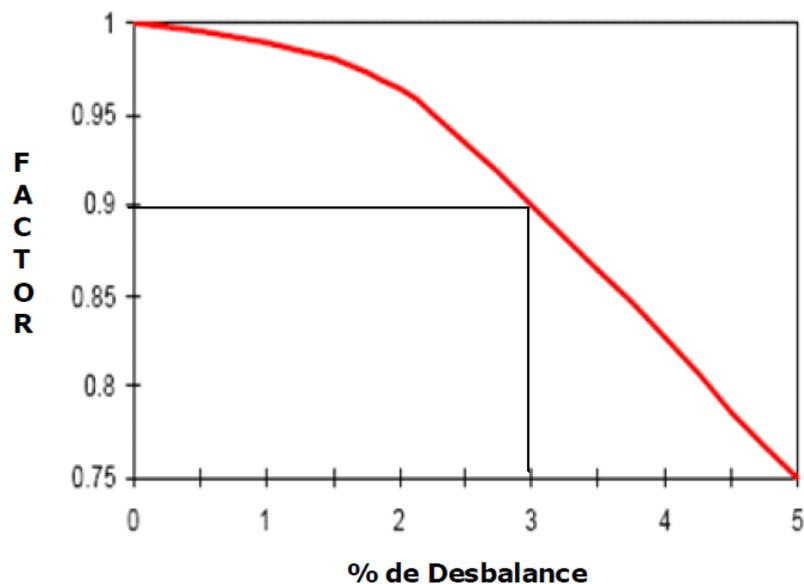
**Figura 30** Factor de corrección de potencia
